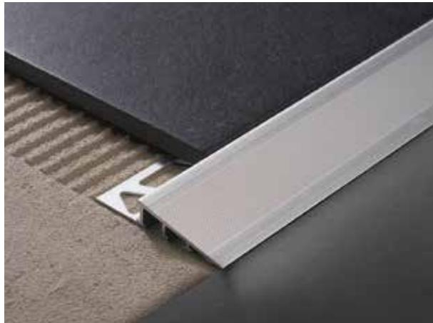
RAMPTEC ZRR è un profilo in alluminio anodizzato studiato per raccordare pavimenti non complanari. L'angolo di inclinazione, pari a 20° circa, crea un raccordo dolce tra i due pavimenti. Il profilo nel lato verticale dispone della caratteristica cava brevettata a "coda di rondine" per un migliore ancoraggio meccanico con la colla e lo stucco, nel punto di maggiore sollecitazione.
